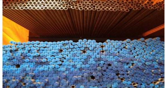
**TUBOS DE AÇO INOXIDÁVEL SEM COSTURA CONFORME ASTM A269, ACABAMENTO CONFORME ASTM A450 E ASME B31.3 (fornecidos em barras de 6 metros)**
